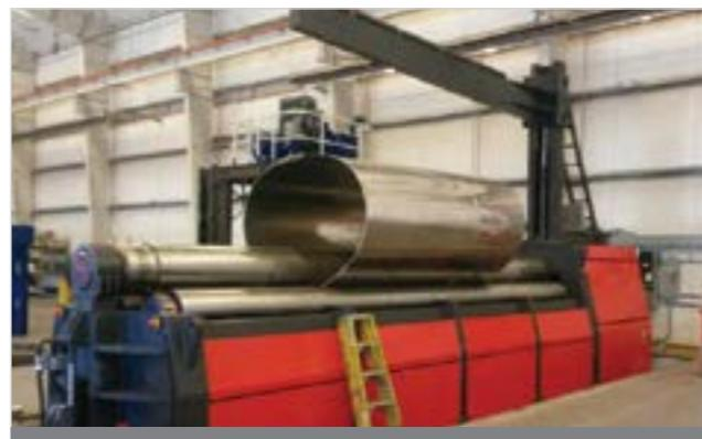
Rouleuses de tôles hydrauliques 4 rouleaux CNC AHS 7700 x 9/12
