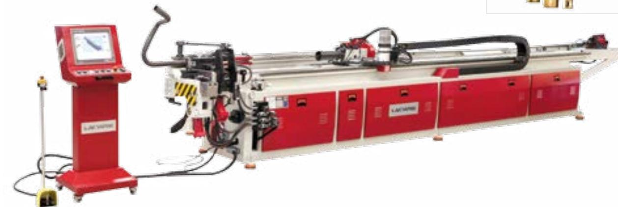
La machine de modèle ABM 76 CNC-1 est capable d'effectuer le cintrage hydraulique des tubes allant jusqu'à 76 mm de diamètre, avec une qualité supérieure. Cette machine effectue les opérations à l'aide d'une seule matrice et facilite les tâches, permet un gain de temps et augmente le rendement en réalisant automatiquement des cintrages successifs grâce au CNC.
