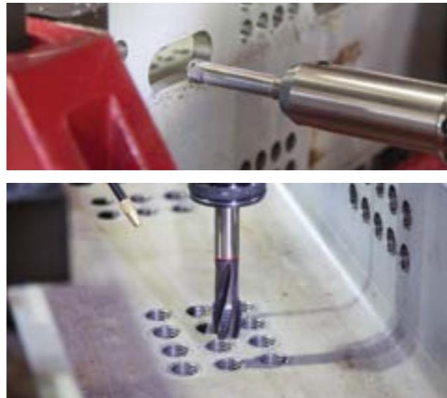
Le matériel (profils, profilés en caisson, angles) sur lequel sera effectuée l'opération de perçage, est tout d'abord placé sur le convoyeur. La pièce maintenue par le bec du bras du chariot est conduite dans la machine de perçage, la position du matériel est réinitialisée à l'aide d'un laser.
