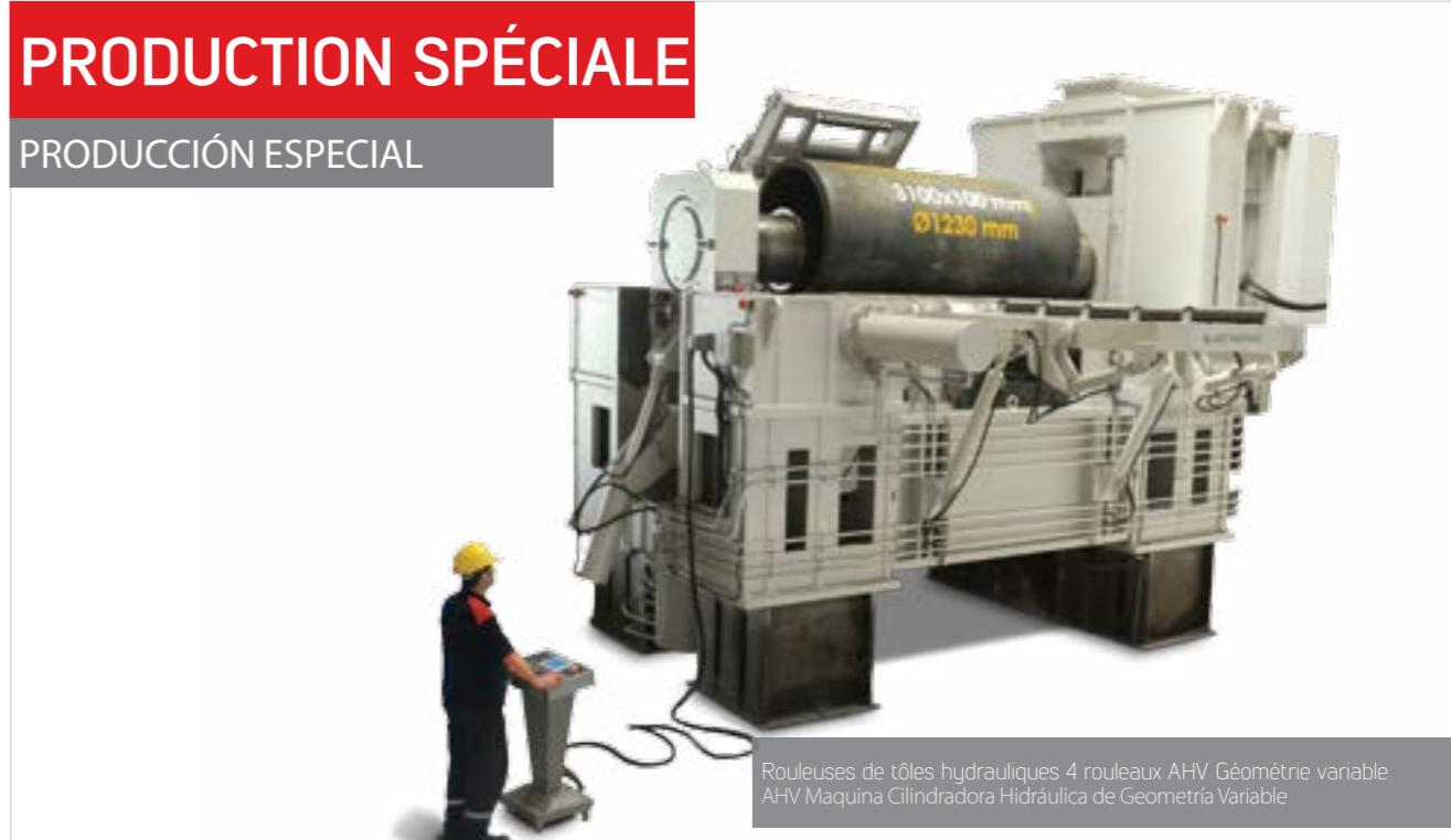
Rouleuses de tôles hydrauliques 4 rouleaux AHV Géométrie variable
