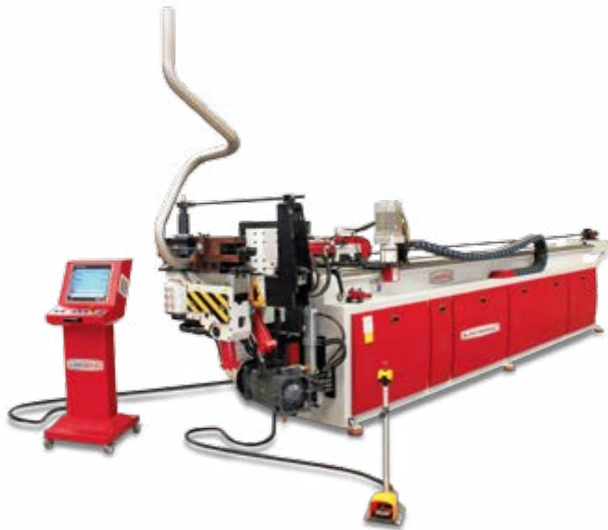
La machine de modèle ABM 76 CNC-3 muni d'un servo est capable d'effectuer le cintrage des tubes allant jusqu'à 76 mm de diamètre, avec une précision et une qualité supérieure. Cette machine offre la possibilité d'effectuer des travaux en trois matrices et facilite les tâches, permet un gain de temps et augmente le rendement en réalisant automatiquement des cintrages successifs grâce au CNC.
