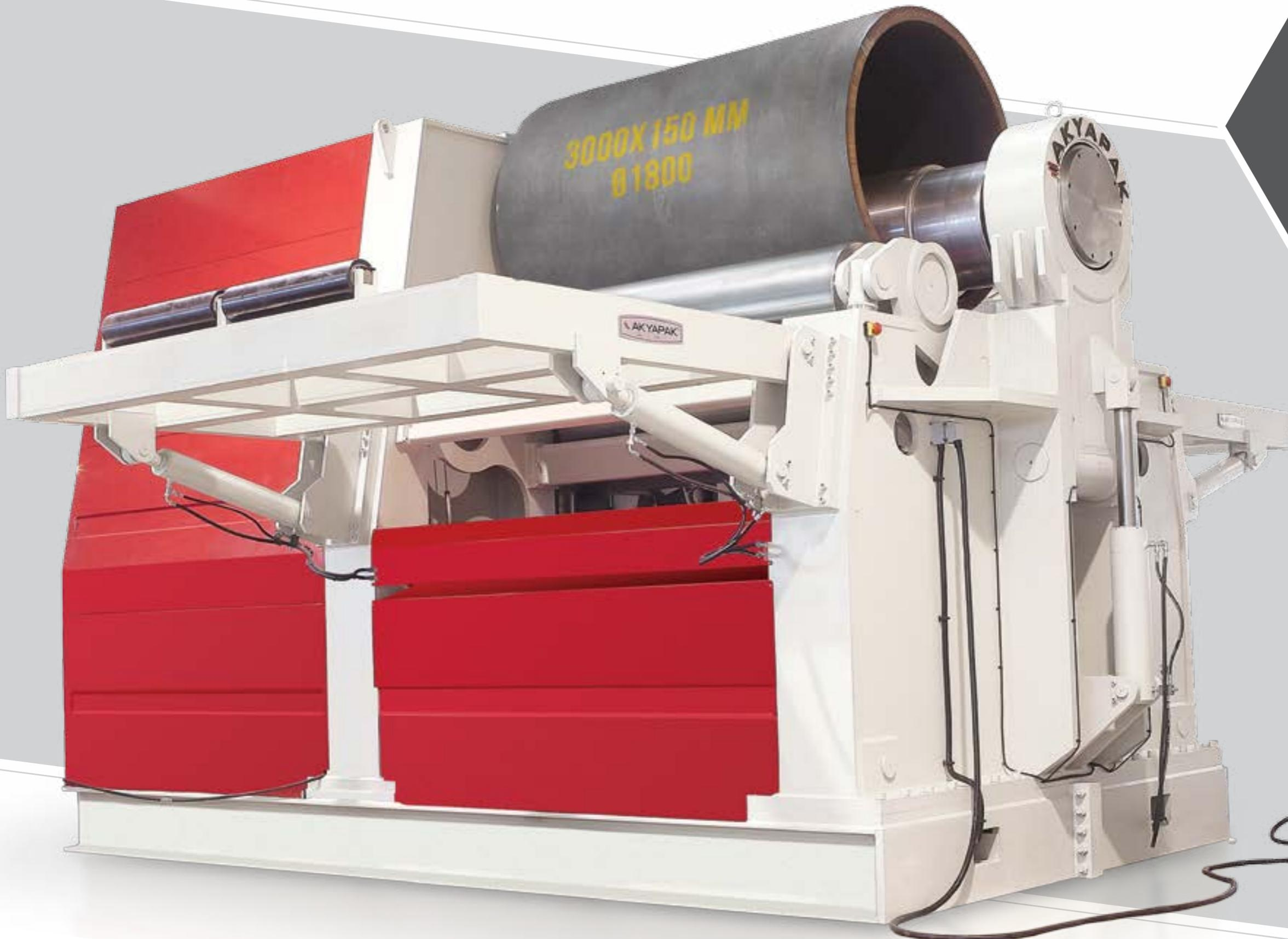
Les rouleuses de tôle hydrauliques quatre rouleaux Akyapak, sont capables d'effectuer facilement un roulage de haute qualité des tôles de 2 à 200 mm d'épaisseur et de 1000 à 12000 mm de largeur.
