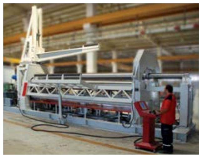
Rouleuse speciale pre-tension pour la production de tube
