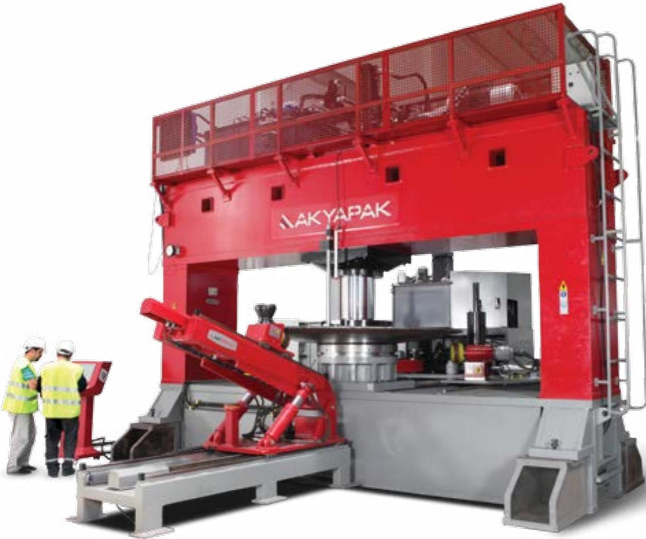
AKYAPAK propose son expérience dans tous les domaines de traitement et de formage du métal. AKYAPAK a développé sa toute première machine à réaliser les fonds bombés tout en effectuant des recherches de solution de haute qualité pour l'industrie du fond bombé.
